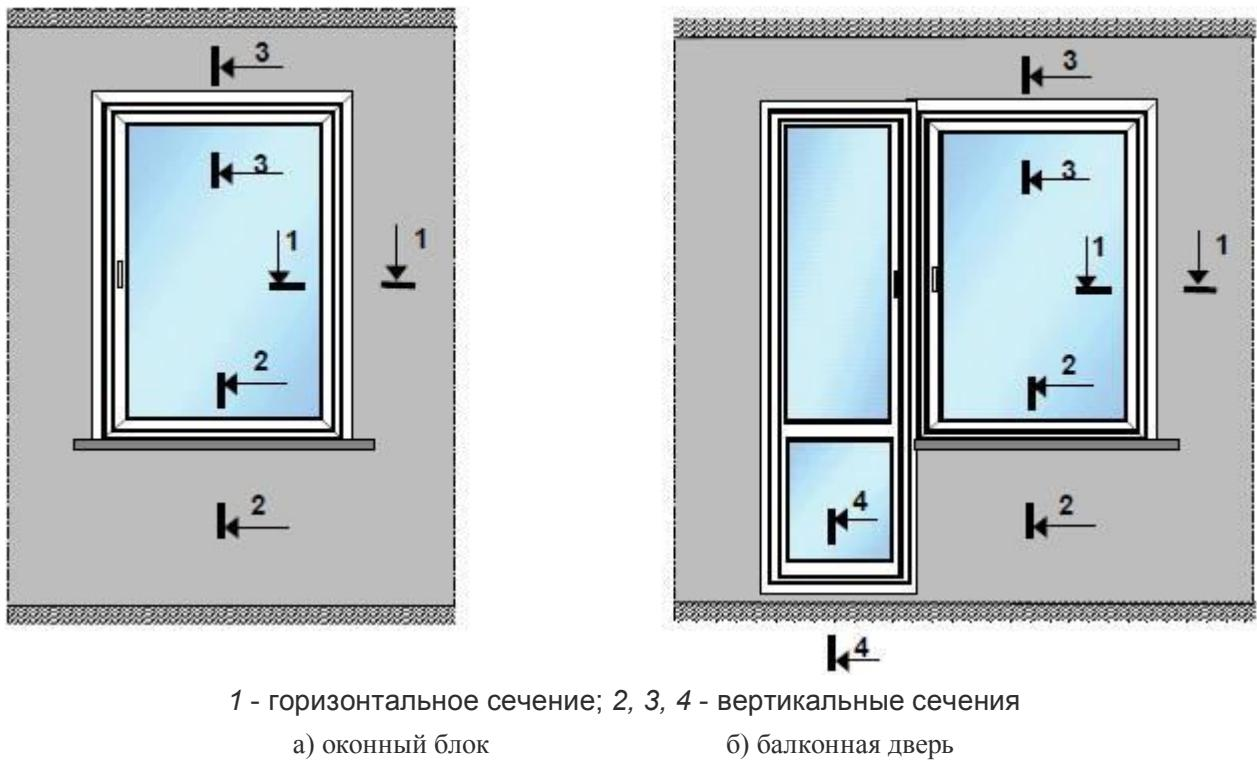
**Рисунок Д.1 - Схема расположения сечений для проверки температурного режима узлов примыканий оконных блоков к наружным стенам**
