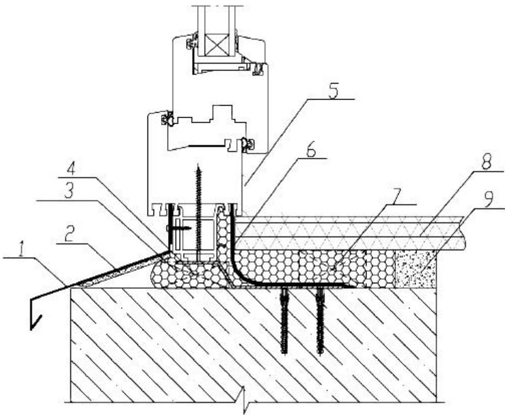
1 - отлив; 2 - шумогасящая подкладка; 3 - пенный утеплитель; 4 - опорная колодка; 5 - уголок из ПВХ; 6 - паронепроницаемый герметик или пароизоляционная лента; 7 - опорный бруск; 8 - подоконник из ПВХ; 9 - штукатурный раствор
