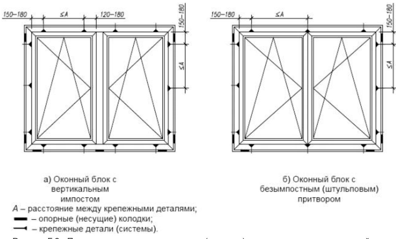
Рисунок Г.3 - Примеры расположения опорных (несущих) колодок и крепежных деталей в одностворчатых оконных блоках
