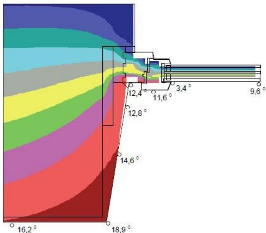
Рисунок Д.3 - Результаты расчета распределения температур по узлу примыкания оконного блока из kleеной древесины к стене из полнотелого кирпича
