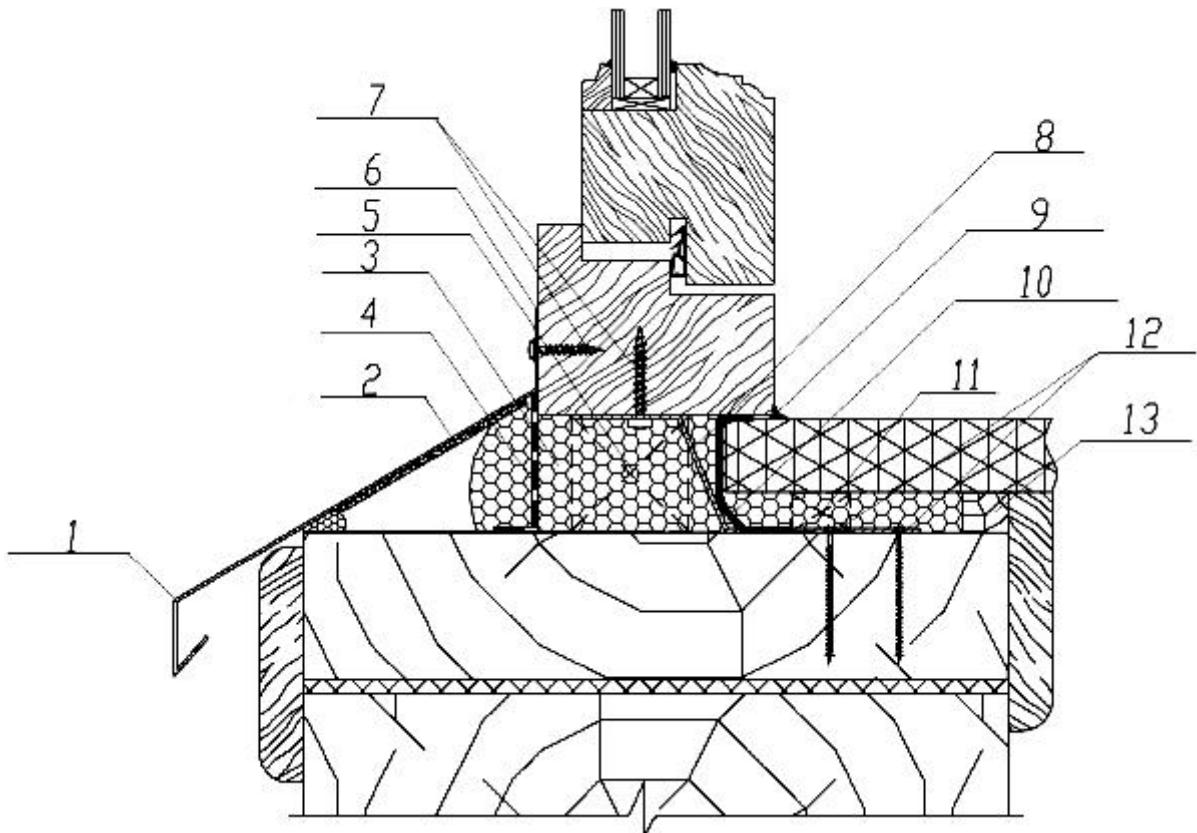
1 - отлив; 2 - шумогасящая подкладка; 3 - пенный утеплитель; 4 - гидроизоляционная лента; 5 - опорная колодка; 6 - силиконовый герметик; 7 - строительный шуруп; 8 - анкерная пластина; 9 - силиконовый герметик; 10 - пароизоляционная лента; 11 - опорный бруск; 12 - строительный шуруп; 13 - антисептированный бруск
