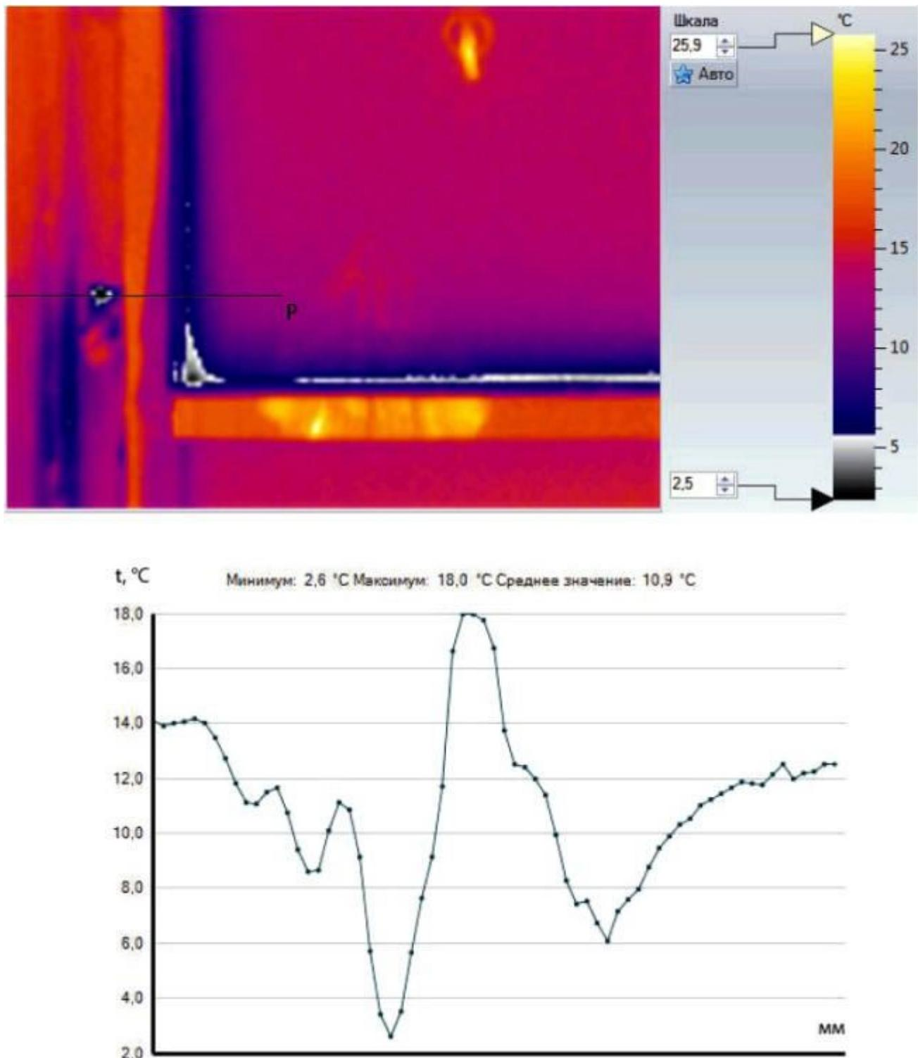
Рисунок Е.1 - Пример проведения тепловизионной съемки внутренней поверхности оконного блока и узла примыкания к стеновой конструкции
