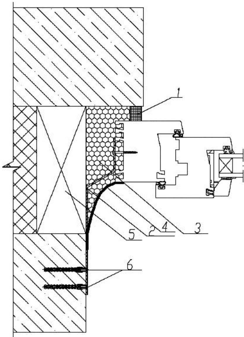
1 - изоляционная саморасширяющаяся паропроницаемая лента (ПСУЛ); 2 - анкерная пластина; 3 - пенный утеплитель; 4 - паронепроницаемый герметик или пароизоляционная лента; 5 - вкладыш из антисептированного пиломатериала; 6 - дюбель со стопорным шурупом
