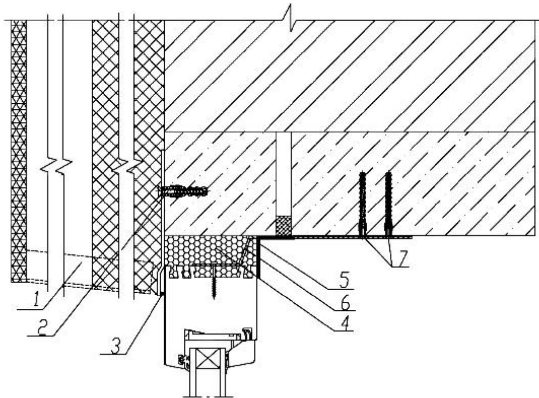
1 - вентилируемый фасад (показан условно); 2 - анкер Ф6х60 (шаг крепления - 500 мм); 3 - паропроницаемый герметик; 4 - пенный утеплитель; 5 - паронепроницаемый герметик, 6 - анкерная пластина; 7 - дюбель со стопорным шурупом
