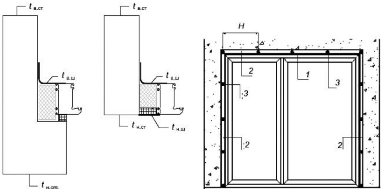
1 - габаритный контур оконного блока; 2 - монтажный шов; 3 - контрольные точки по периметру оконного проема для измерения температур на внутренней поверхности шва;  $t_{в.ст}$  - температура внутренней поверхности стены;  $t_{н.ст}$  - температура наружной поверхности стены;  $t_{в.ш}$  - температура внутренней поверхности шва;  $t_{н.ш}$  - температура наружной поверхности шва;  $H$  - расстояние от плоскости оконного проема до точки замера
