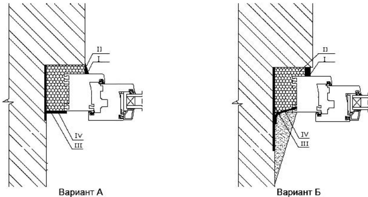
I - наружный водоизоляционный паропроницаемый слой;
